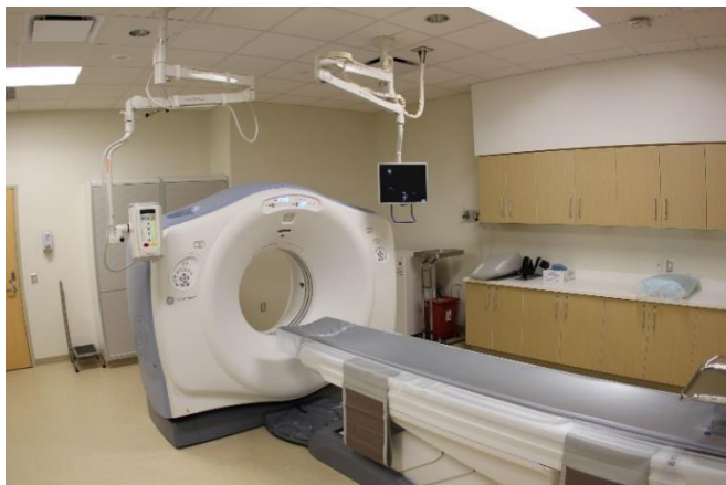
Multislice spiral-CT med åtte snitt per rotasjon, hvor pasienten sakte beveges gjennom kilde-detektor-systemet. Opphav: https://commons.wikimedia.org . Lisens: https://creativecommons.org/licenses/by/2.0/deed.en
